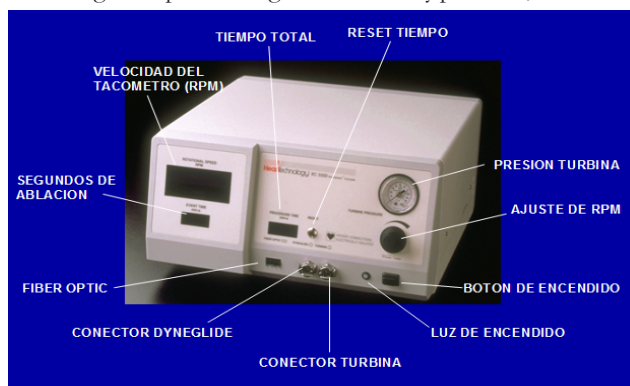
Imagen 24.1.2. Consola de monitorización y control de la velocidad
